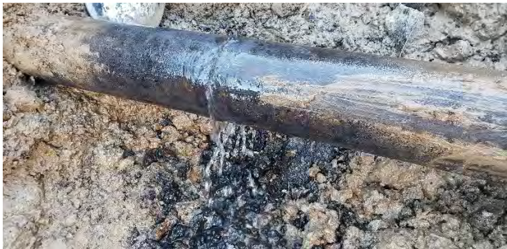
Classic Beam break on 4 inch DI pipe. (Ductile Iron)
